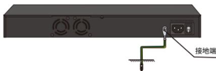
图1.3.1 产品接地示意图
