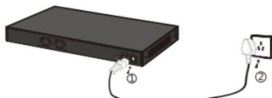
图1.2.2 电源连接示意图
