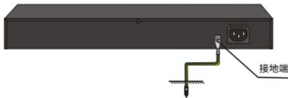
图1.3.1 产品接地示意图
