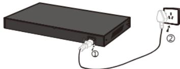
图1.2.2电源连接示意图
